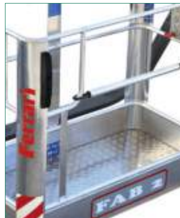
SCHWERKRAFTVER- SCHLUSS IM EINSTIEG
